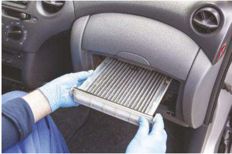
↑ La rimozione di un filtro sporco, a fini di opportuna sostituzione
